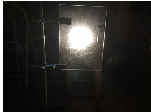
写真 1 結露を用いた光環の作成
